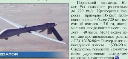
tax 914 позволяет разогнаться до 220 км/ч. Крейсерская скорость - примерно 135 км/ч, дальность полета - более 720 км, высотный потолок - 7.6 км, максимальная продолжительность полета -40 часов. MQ-1 может нести две противотанковые ракеты AGM-114 Hellfire. Размер взлетнопосадочной полосы - 1500×20 м. Следующее поколение самолетов имеет улучшенные тактико-технические характеристики. 🥸
