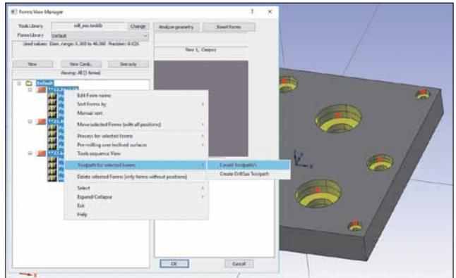
Рис. 5. Пункт меню для генерации траекторий. На выбор предлагаются: режим 3+2 оси или, при возможности, 5-осевое сверление
