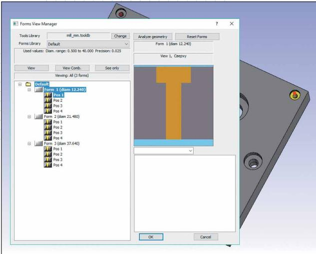
Рис. 2. Окно Менеджера отверстий со списком обнаруженных отверстий
