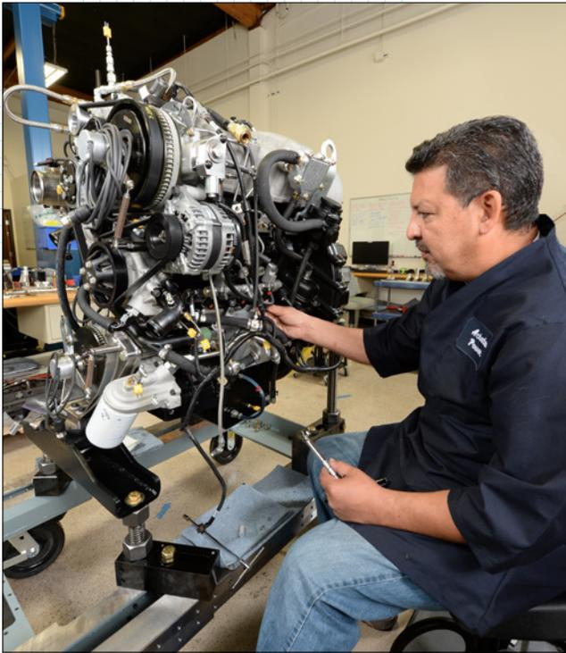
*Manny Rodriguez работает над прототипом 2.7-литрового двигателя мощностью 270 лошадиных сил*
