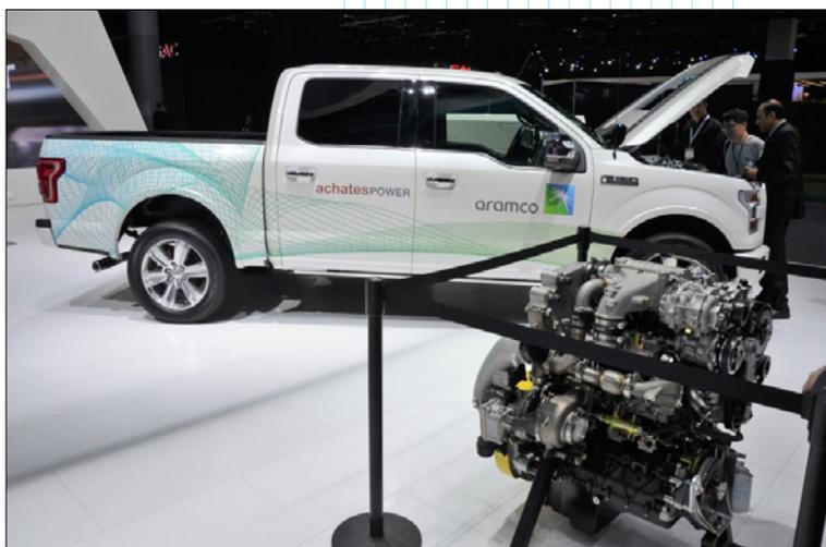
*Многолетние испытания в партнерстве с компанией Aramco 2.7-литрового двигателя с оппозитными поршнями, установленного на малотоннажный пикап, убеждают в способности соответствовать текущим и будущим федеральным нормативам выбросов транспортных средств и стандартам экономии топлива, а также способствуют появлению нового эталона эффективности.*
