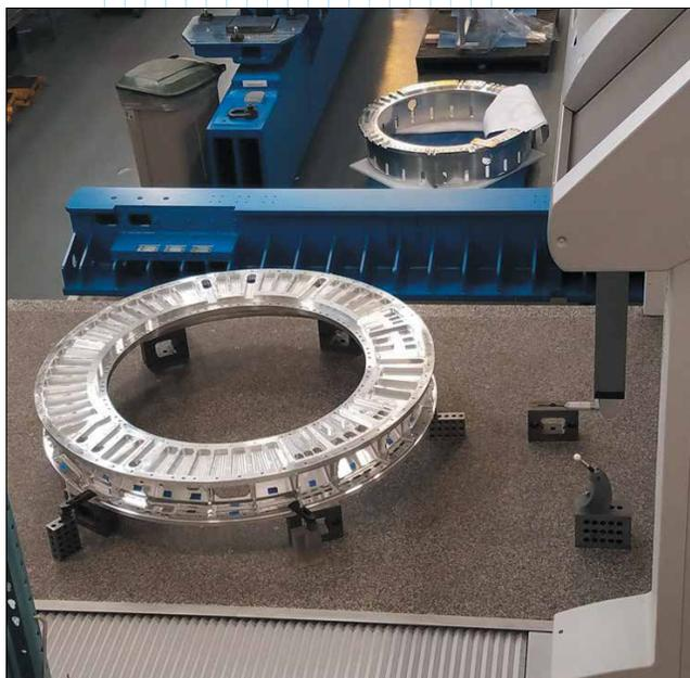
Для проверки заднего фланца компания *Keller* использовала координатно-измерительную машину *Global Advantage*. Кроме того, на этапе инспектирования присутствовали представители SLAC, что позволило уточнить допуски “на лету” в случае необходимости. (Фотография предоставлена компанией *Keller Technology*)
