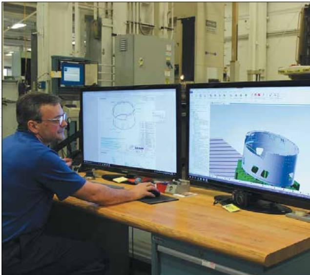
*Инженер-технолог Scott Steggs за работой. Одним из преимуществ использования CAD/CAM-системы Mastercam является полный контроль процесса и возможность готовить УП в автономном режиме, когда станки в цехе обрабатывают другие детали. (Фотография предоставлена компанией Keller Technology)*
