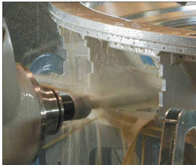
*Задний фланец диаметром 1.65 метра будет соединять камеру с остальной частью телескопа. Использование термодатчиков для посадки инструмента с обжимом, в сочетании с очень маленькой глубиной резания, позволили снизить вибрацию и повысить точность обработки. (Фотография предоставлена компанией Keller Technology)*
