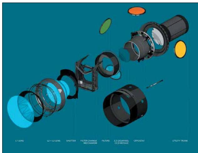
Цифровая камера *LSST* состоит из ряда подсистем. Компания *Keller Technology* изготовила для этого проекта две детали: корпус камеры (показан внизу) и задний фланец. (Иллюстрация *SLAC National Accelerator Laboratory*)
