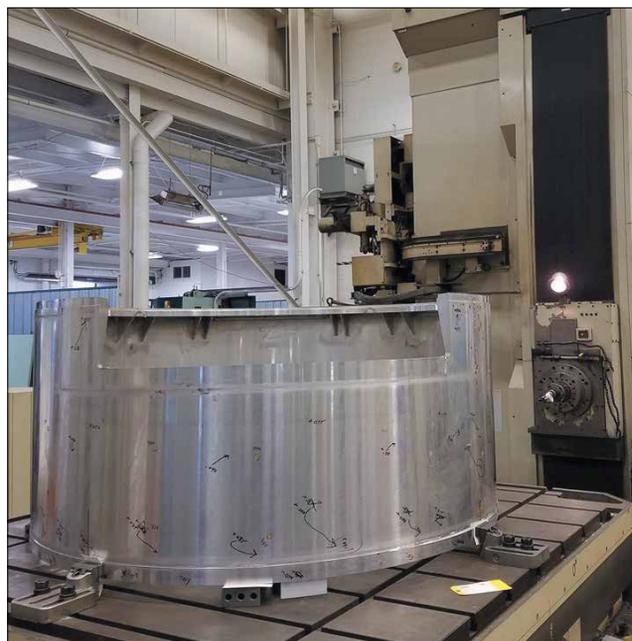
Корпус камеры, после первой попытки снять остаточные механические напряжения, был установлен на столе горизонтального фрезерно-расточного станка *Toshiba Shibaura BF-130B*. Это обеспечило удобство при проведении измерений, необходимых для определения того, какие области детали не соответствуют спецификациям SLAC. (Фотография предоставлена компанией *Keller Technology*)
