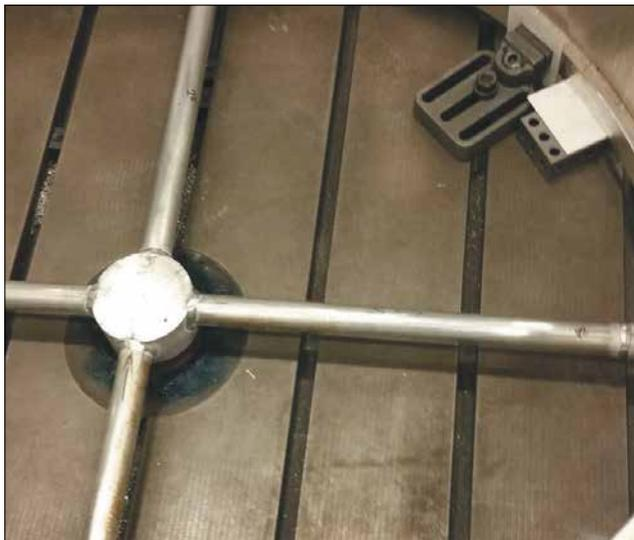
*После растягивания корпуса камеры до нужных размеров, в него были сварены две крестовины для фиксации. Вся эта конструкция была повторно отправлена для снятия остаточных внутренних напряжений.
