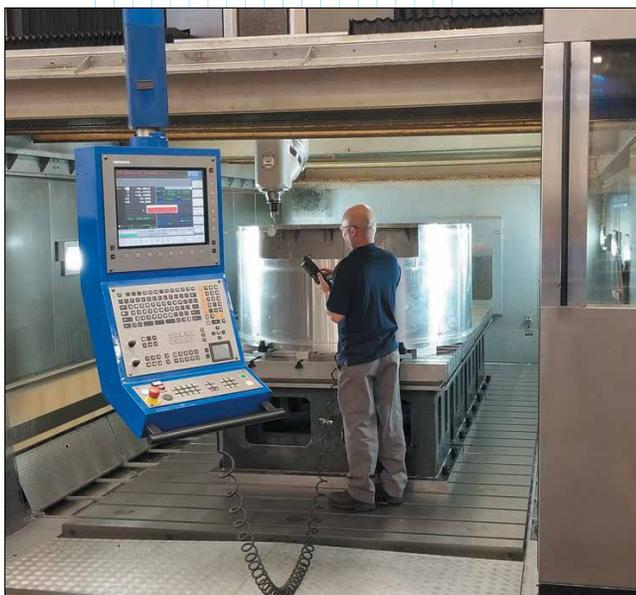
После повторной операции снятия остаточных механических напряжений в корпусе камеры, крестовины были удалены. Дальнейшая обработка корпуса велась на станке *Parpas XS 63*. (Фотография предоставлена компанией *Keller Technology*)
