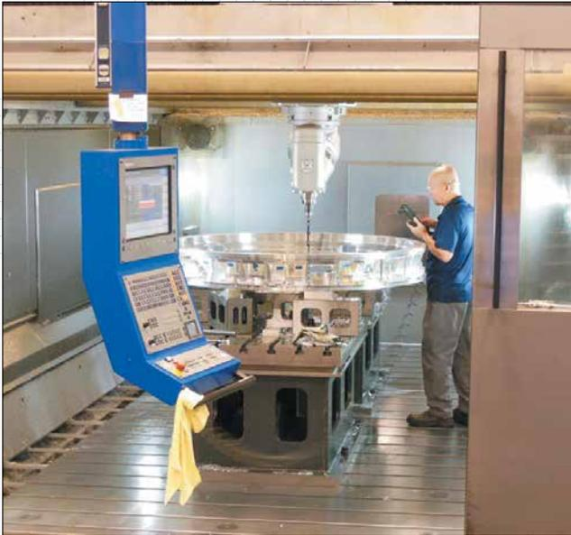
*Портальная конструкция и большая рабочая зона обрабатывающего центра Parpas XS 63 в сочетании с гибкими возможностями 5-осевой высокоскоростной фрезерной головки позволили обработать фланец всего за два установка.*
