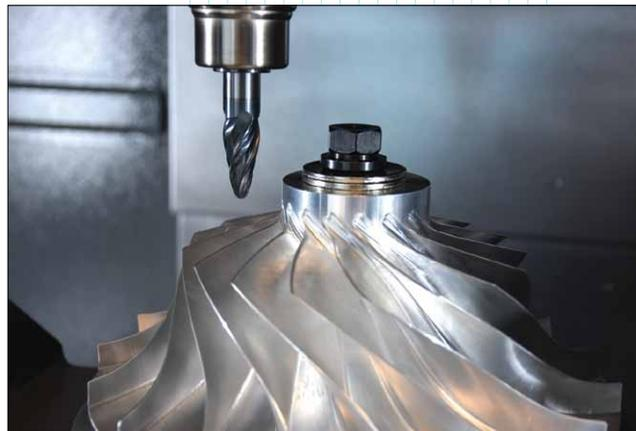
компонентов, необходимых в оборонной, аэрокосмической, судостроительной, энергетической промышленности. Эти пластинки являются очень твердыми, но легко зазубриваются, имеют склонность к вибрации и ограниченный срок службы – этому способствуют свойства материала, испытываемые нагрузки и характер износа при использовании стандартных линейных траекторий.
