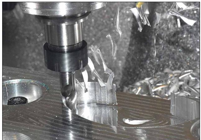
*Разработчики САМ-систем и поставщики инструмента тесно сотрудничают, чтобы новые траектории соответствовали рекомендациям поставщика по оптимальной толщине снимаемой стружки. (Иллюстрация предоставлена компанией CNC Software, Inc.)*
