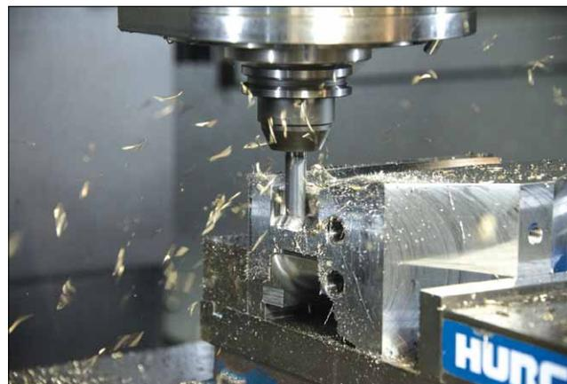
части и углом конуса 4°. В другом варианте конструкции три зуба расположены на закругленной части, и шесть зубьев – радиально. Алюминиево-хромовое покрытие позволяет очень эффективно резать труднообрабатываемые материалы на более высоких скоростях подачи с большей скоростью съема металла.
