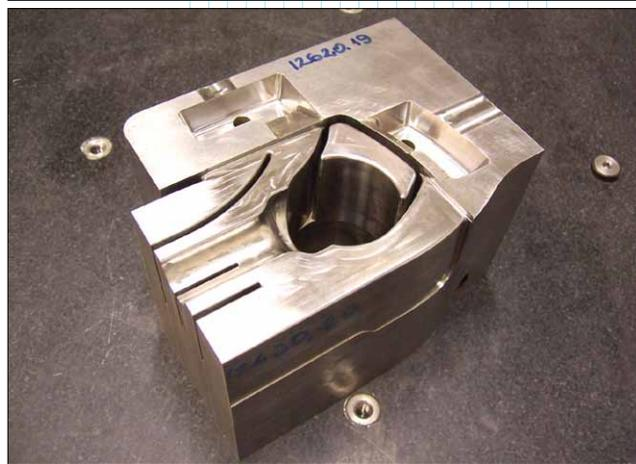
*Формообразующие вставки пресс-форм для литья алюминия. Закаленная инструментальная сталь*
