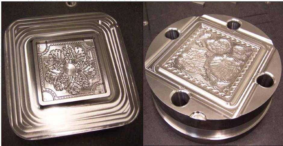
*Матрицы из закаленной стали. При подготовке траекторий обработки в Mastercam использовались различные варианты расчета с учетом заготовки*
