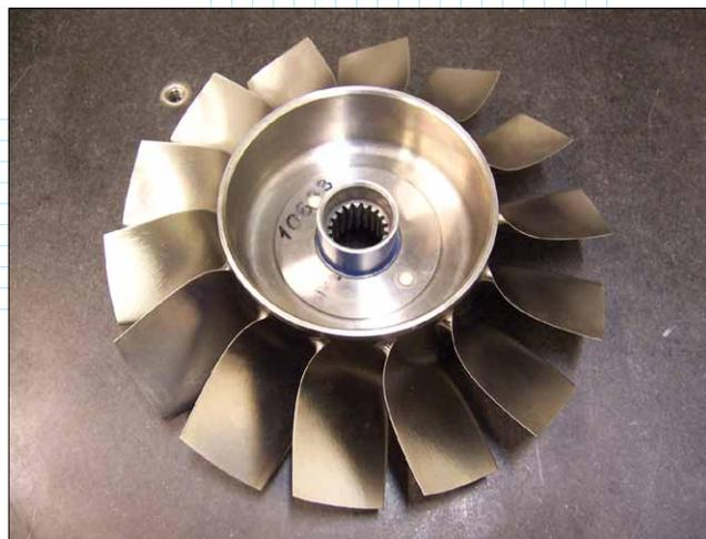
*Изделие с лопатками из титанового сплава. Все траектории для обработки лопаток (черновые, получистовые и чистовые) были сгенерированы средствами CAD/CAM-системы *Mastercam**
