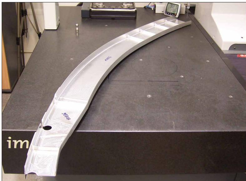
*Сегмент шпангоута из авиационного алюминиевого сплава В950чТ2. Стенки представляют собой поверхности с переменными углами наклона, в том числе и с отрицательными. При обработке стенок на 3-осевом фрезерном центре использовались слотовые фрезы*
