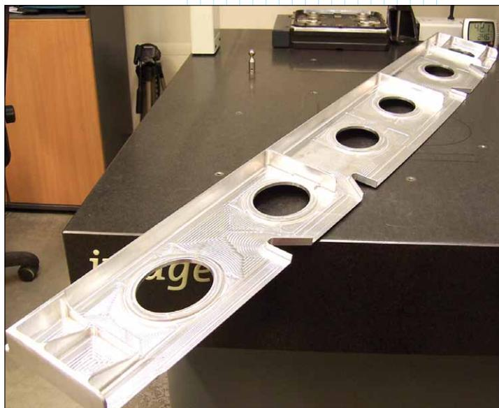
*Фитинг из алюминиевого сплава 1163Т. С помощью функций твердотельного моделирования CAD/CAM-системы Mastercam перед программированием обработки были построены скругления всех острых кромок*
